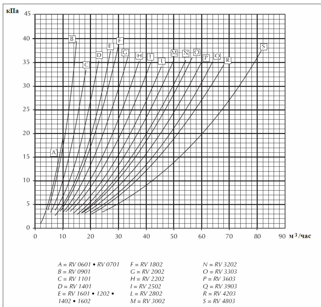
Приведенные выше значения падения давления соответствуют средней температуре воды на выходе, равной 50°C. В приводимой ниже таблице указаны поправочные множители, соответствующие другим значениям средней температуры.
