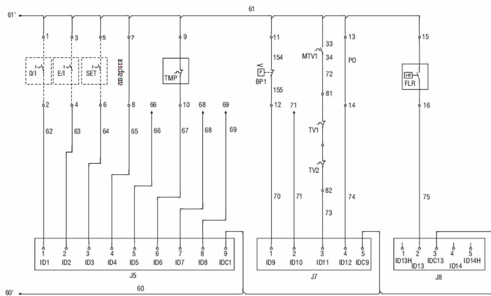
**ПОДКЛЮЧЕНИЕ ЗАЩИТНЫХ УСТРОЙСТВ (ДВУХКОМПРЕССОРНЫЕ МОДЕЛИ)**
