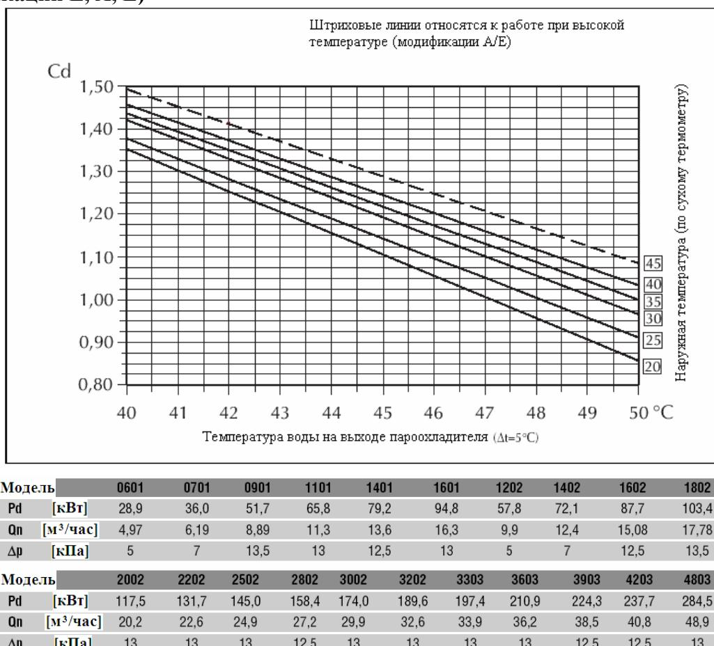
$P_d$  = теплопроизводительность пароохладителя при номинальных условиях: наружная температура 35°C, температура воды выходе пароохладителя 50°C
