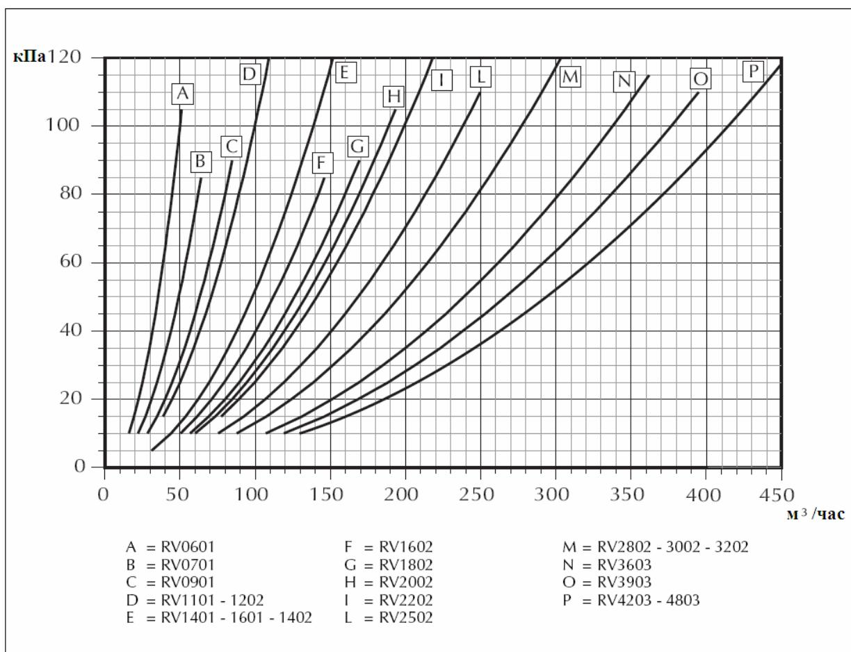
Приведенные выше значения падения давления соответствуют средней температуре воды на выходе, равной 50°C. В приводимой ниже таблице указаны поправочные множители, соответствующие другим значениям средней температуры.
